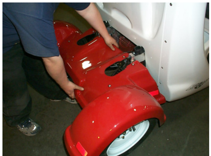
Fig. # 11 Remove spat
